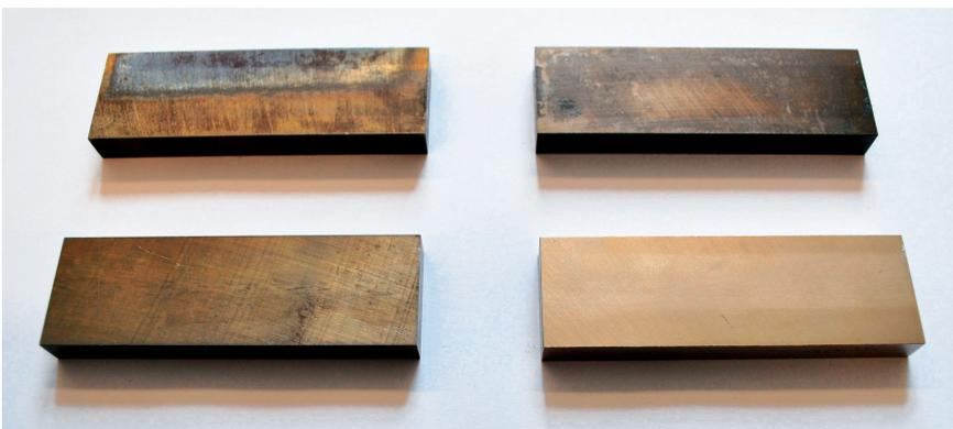
**Bild 2.** Rückstände des Haftklebstoffs nach der Schälzuguntersuchung. Oben links: unbehandelt; oben rechts: Teniferierung; unten links: FOTS; unten rechts: CNB. © KTP
